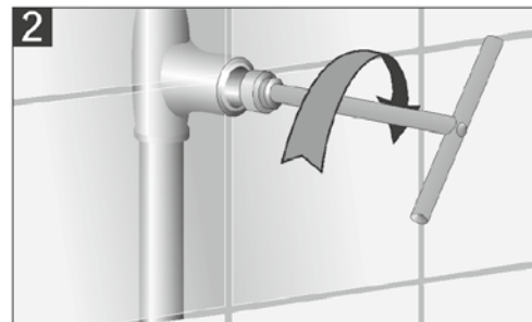
Ventileinsatz mit Fräser reinigen und Fremdkörper entfernen
